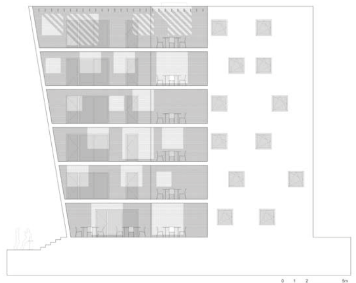
Non-façade intérieure. Les portes et fenêtres sont réparties selon une grille fonctionnelle qui traduit la superposition d'étages identiques. Si les baies carrées sont toujours disposées de façon diverse elles offrent à chaque étage la même surface totale d'ouverture et donc de lumière et d'aération.
